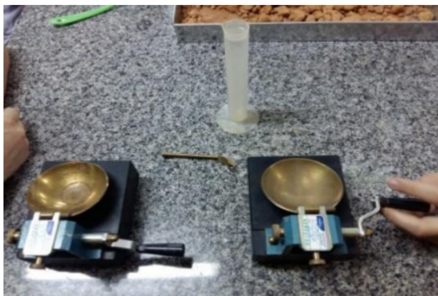
FOTOGRAFIA 1 – Aparelho de Casagrande
